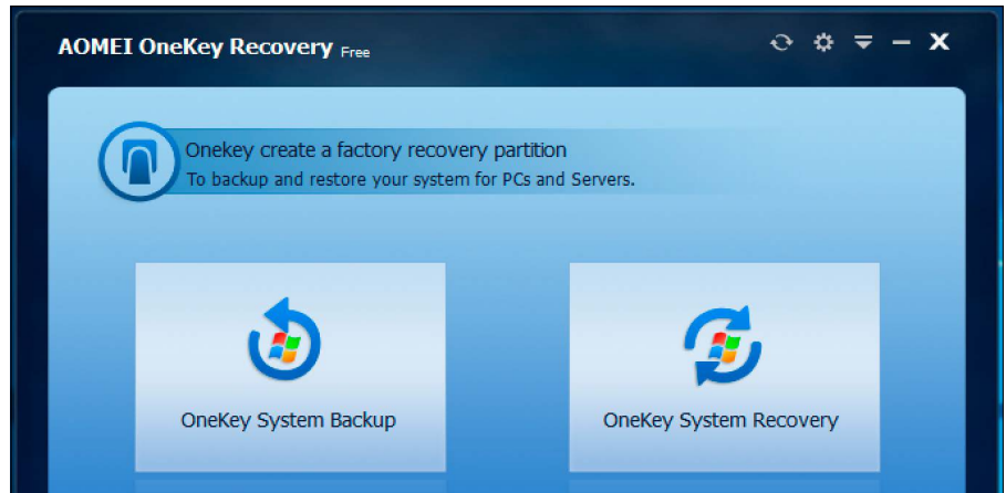
Rettungsschirm: Onekey Recovery sichert das komplette System in einer Wiederherstellungspartition. Über den Bootmanager sichern Sie das System zurück, auch wenn Windows nicht mehr startet.
