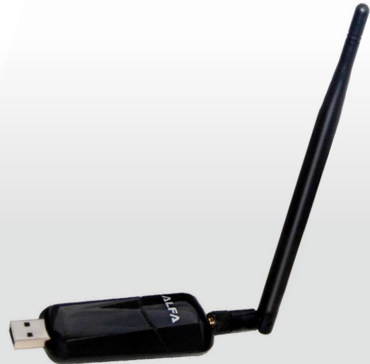
Knapp 20 Euro kostet ein solcher Wi-Fi-USB-Adapter, mit dem sich die Senderleistung eines kompromittierten Hotspots auf ein Watt erhöhen lässt – erlaubt ist nur ein Zehntel dessen.
