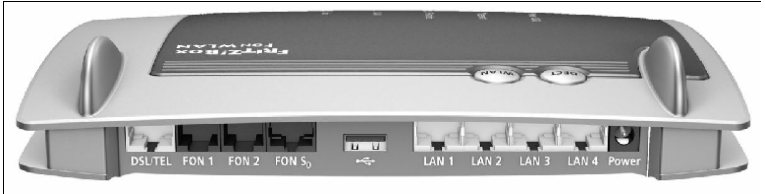
Bild 2.1 Die DSL/TEL-Buchse (links) stellt die Verbindung zum Internet Service Provider her.
