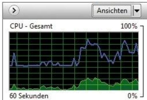
Grafische Darstellung der CPU-Auslastung: Der grüne Bereich zeigt die aktuelle Gesamtauslastung des Prozessors. Die blaue Linie gibt an, wie viel Prozent der maximalen Prozessortaktrate genutzt werden
