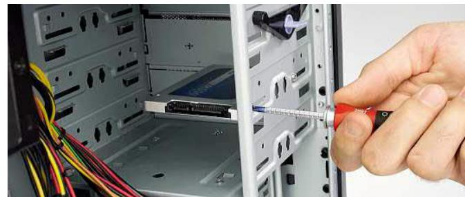
**Im Desktop-PC können Sie eine SATA-SSD mit zwei Schrauben am Rand eines 3,5- oder 5,25-Zoll-Laufwerkskäfigs festschrauben**
