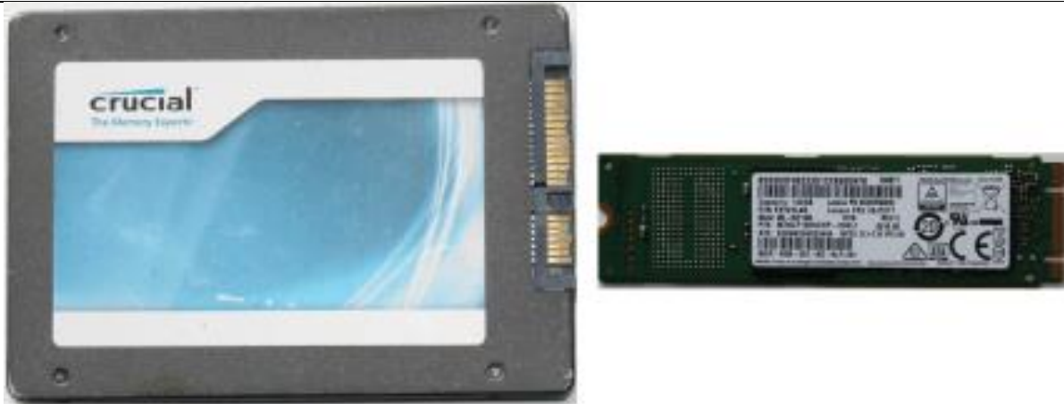
Abb. Zwei Formfaktoren von SSD-Speichergeräten: 2,5" (links) und M.2 (rechts).
