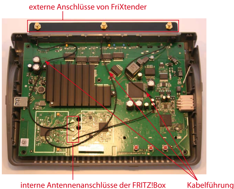
Der FriXtender-Bausatz führt die internen Antennenanschlüsse nach außen auf Standard-Antennenbuchsen
