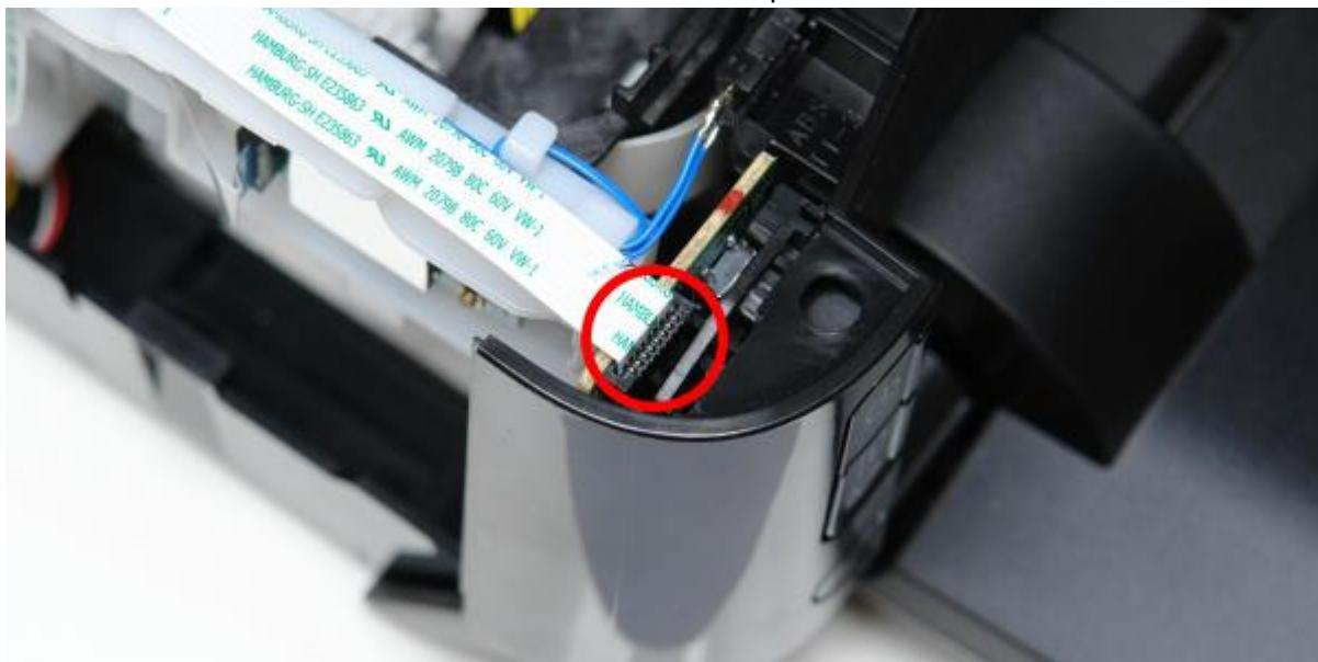
**Raus damit:** Ziehen Sie das Flachkabel vorsichtig aus dem Stecker am Tastenpanel.
