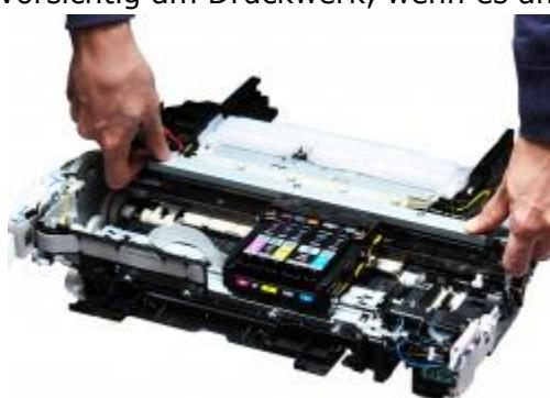
⊕**Druckwerk anheben:** Greifen Sie das Druckwerk dazu an den Enden der Metallschiene.
