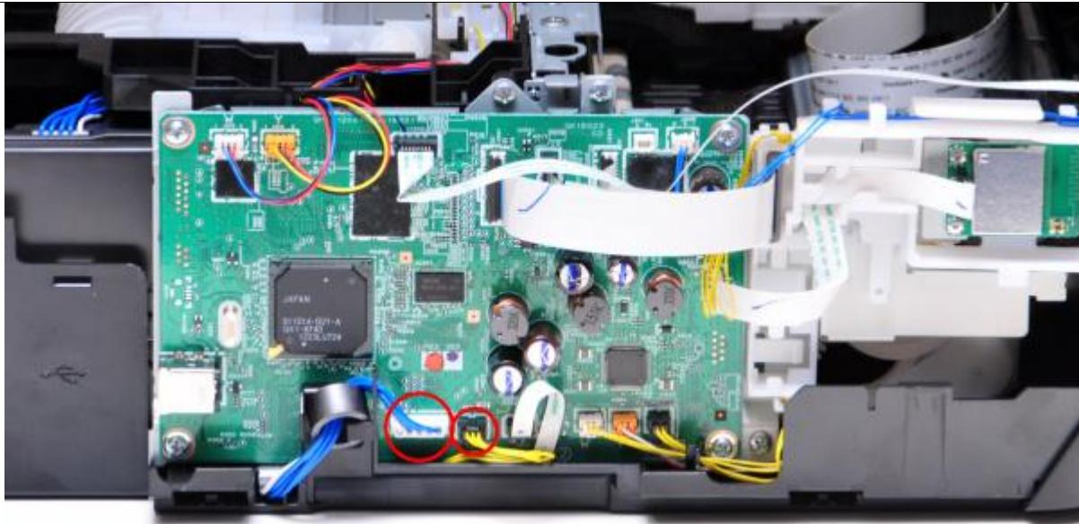
**Kabel ausstecken:** Ziehen Sie die beiden rot markierten Stecker (unten) von der Platine des Druckers ab.
