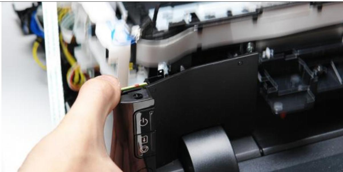
**Druckwerk einsetzen:** Ziehen Sie das Tastenpanel etwas nach vorne, damit sich das Druckwerk mit seinen Kabeln nicht daran verhakt.
