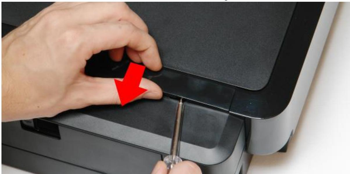
**Zierleiste entfernen:** Schieben Sie einen Schraubendreher in die Aussparung, drücken Sie damit den Clip etwas nach unten und ziehen Sie die Zierleiste gleichzeitig vom Drucker weg.
