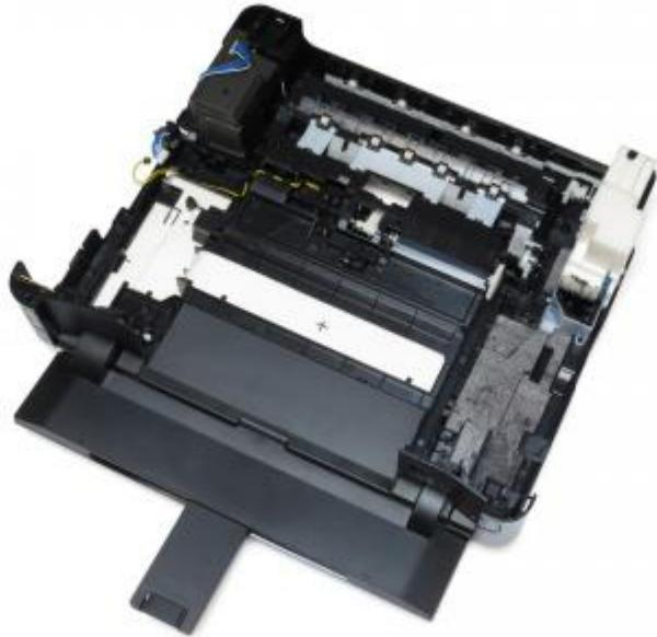
**☒ Bodeneinheit des Druckers:** Zahlreiche Schwämme verteilen sich auf den Gehäuseboden und eine Plastikbox rechts hinten.
