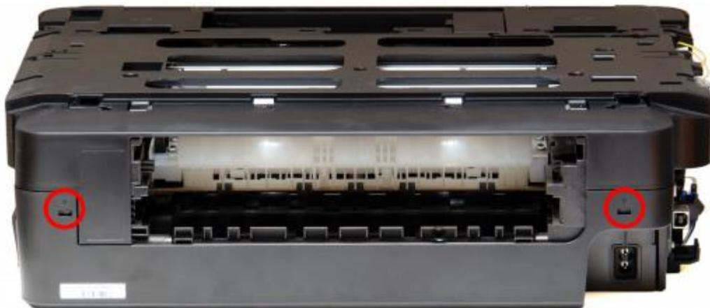
**Rückseite:** Lösen Sie die beiden markierten Clips mit einem Schraubendreher.
