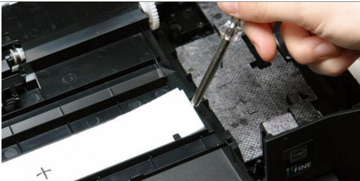
**Alte Schwämme entfernen:** Nehmen Sie am besten ein Werkzeug zur Hilfe.
