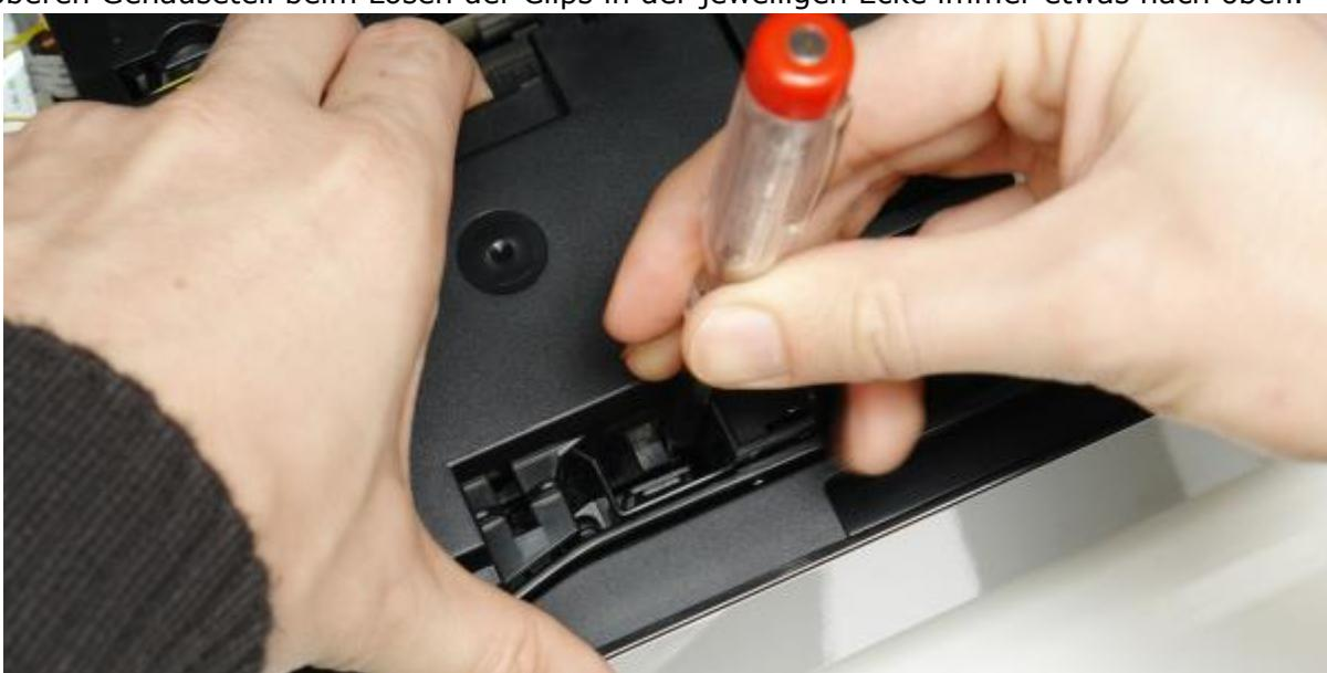
⊕**Clip lösen:** Drücken Sie den Clip zur Seite und ziehen Sie den Gehäuseteil gleichzeitig nach oben.
