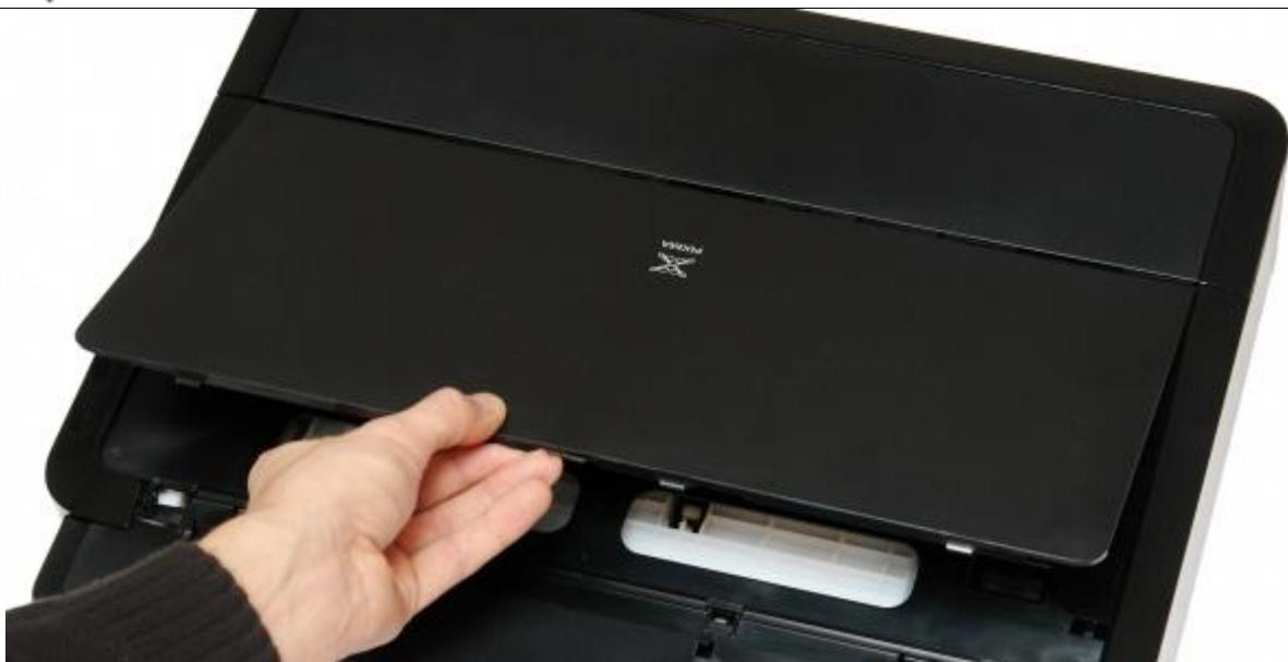
**Große Abdeckung entfernen:** Klappen Sie die Abdeckung zunächst hoch, um Sie dann nach oben abnehmen zu können.
