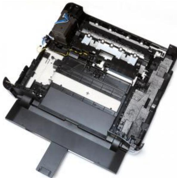
**Nach dem Entfernen der Plastikbox:** Bodeneinheit des Druckers mit verbleibenden Schwämmen.
