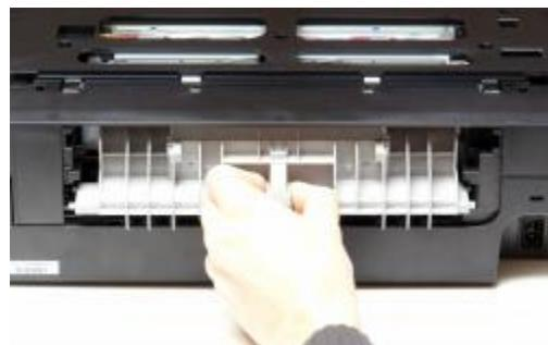
**Grauer Einschub:** Ziehen Sie diesen einfach aus dem Drucker.
