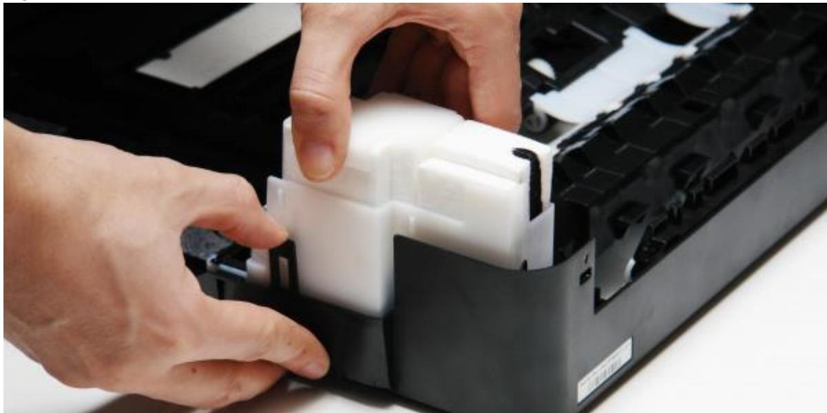
**Box herausnehmen:** Drücken Sie den schwarzen Plastikclip nach außen und entfernen Sie die Plastikbox nach oben.
