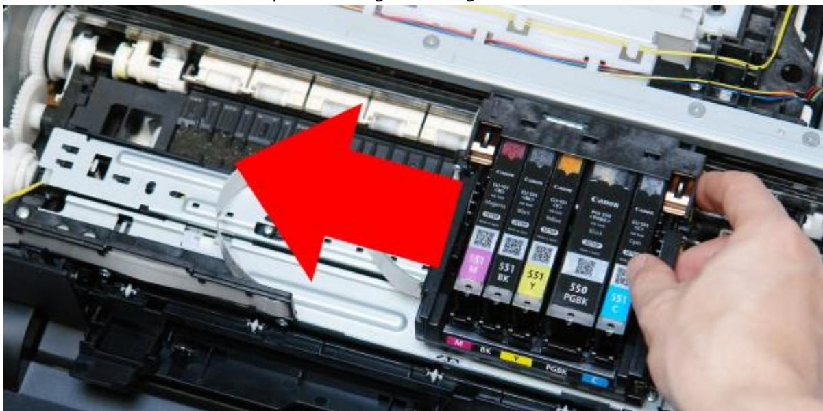
**Ab in die Mitte:** Schieben Sie den Druckkopfschlitten von seiner Parkposition weg, um eine weitere Schraube zugänglich zu machen.
