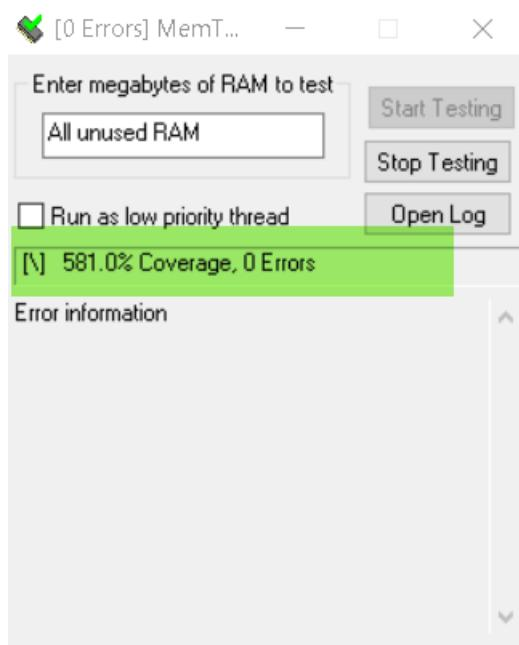
Wenn Fehler gefunden werden, wird das im unteren Bereich des Fensters angezeigt. Dann muss der Arbeitsspeicher gewechselt werden.
