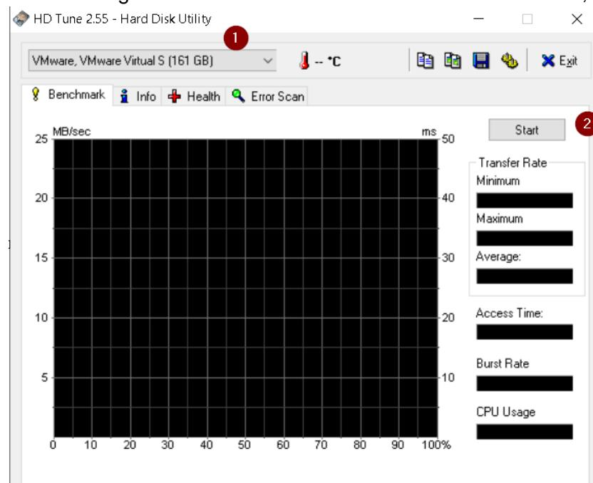
Beim Benchmark-Test, sollte die Linie möglichst waagerecht verlaufen ohne große Sprünge
