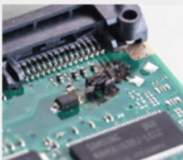
Bei einer elektrischen Beschädigung startet die Festplatte gar nicht, oder das Netzteil schaltet sich automatisch aus. Das passiert ganz oft bei einem Kurzschluss, Überspannungen, höherer Auslastung, statischen Aufladungen, defektem/minderwertigem Netzteil, oder wenn eine externe Festplatte an ein falsches Netzteil (z.B. Notebook Netzteil) angeschlossen wird.
