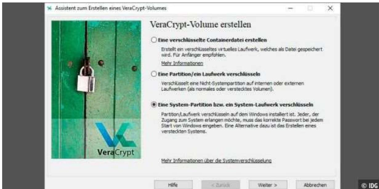
**Vergrößern** Wählen Sie in Veracrypt die Funktion „Volume erstellen → Eine System-Partition bzw. ein System-Laufwerk verschlüsseln“, um Ihr Laufwerk mit Windows zu verschlüsseln. Sicherheitshalber: Erstellen Sie vorher ein Backup.
