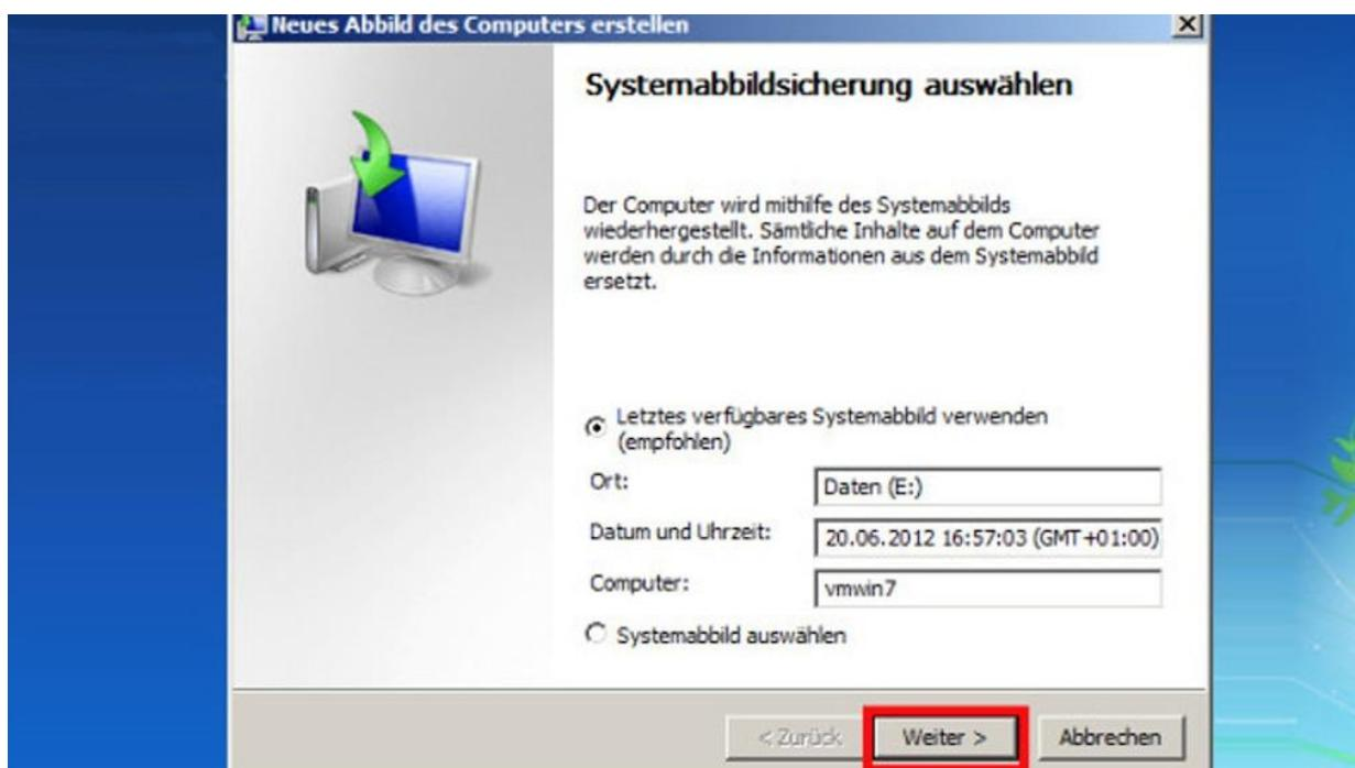
Lassen Sie die Einstellung "Letztes verfügbares Systemabbild verwenden" unverändert, stellt Windows die neuste Komplettsicherung wieder her. Bei Bedarf können Sie unter *Systemabbild auswählen* ein früheres Backup auswählen. Nach zwei Klicks auf *Weiter*, *Fertigstellen* und *Ja* wird das Datenträgerabbild zurückgespielt.
