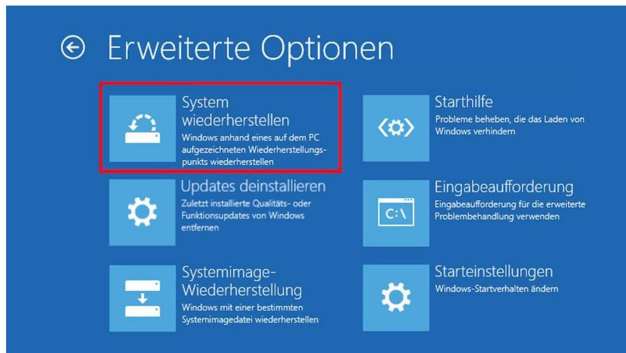
Bei Startproblemen sollte Windows automatisch in die Wiederherstellungsumgebung (Bild) wechseln. Um das zu erzwingen, unterbrechen Sie den PC-Start bei Erscheinen der kreisenden Punkte zweimal, indem Sie die Einschalttaste gedrückt halten. Danach klicken Sie gegebenenfalls auf *Erweiterte Reparaturoptionen anzeigen*, *Problembehandlung*, *Erweiterte Optionen*, *System wiederherstellen* und Ihr Benutzerkonto. Nach Eingabe des Windows-
