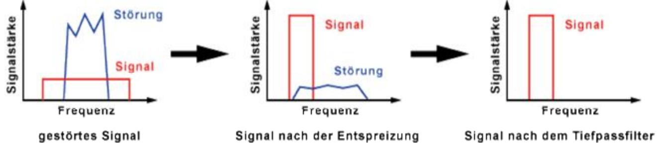
Der Empfänger kehrt diesen Prozess um. Er multipliziert das empfangene Signal mit den Spreizsignalen (Pseudo-Noise-Code). Diesen Vorgang nennt man Entspiegelung. Anschließend werden durch einen Tiefpassfilter die unerwünschten schmalbandigen Störungen herausgefiltert. Das ursprüngliche Signal bleibt übrig.
