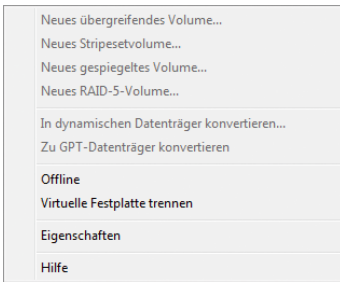
Abbildung 6.28 Über das Kontextmenü der virtuellen Festplatte trennen Sie diese vom Computer wieder.
