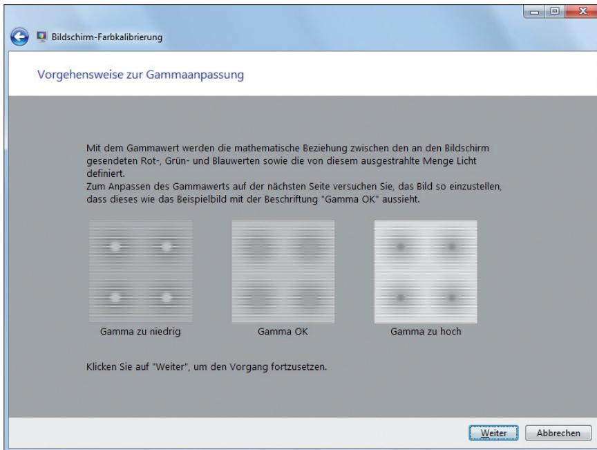
Bildschirm-Kalibrierung: Das neue Tool Dccw von Windows 7 optimiert die Darstellungsqualität von Bildern auf dem Monitor. Ein Assistent leitet Sie durch die Konfiguration (Bild H)
