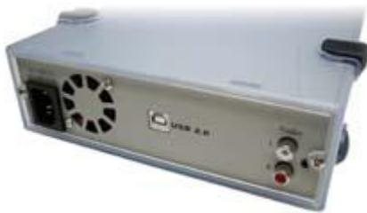
Für den externen Anschluss wird ein entsprechendes Kaltgerätekabel benötigt. Ein Kabel für Deutschland/Frankreich ist im Lieferumfang enthalten. Kaltgerätekabel für England, Italien, USA, Japan und die Schweiz können ebenfalls über partsdata bezogen werden.
