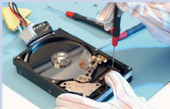
Feinmechanik: Der Austausch eines defekten Schreib-Lese-Kopfes kann eine mechanisch beschädigte Festplatte wiederbeleben
