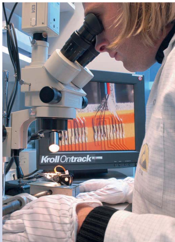
Erste Kontrolle: Die Verbindungen zwischen Schreib-Lese-Köpfen und Preamp (Vorverstärker) werden auf Kontakt überprüft
