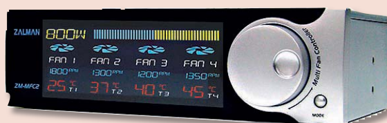
Zalman ZM-MFC2: Die Steuereinheit regelt vier Lüfter und besitzt vier Temperatursensoren
