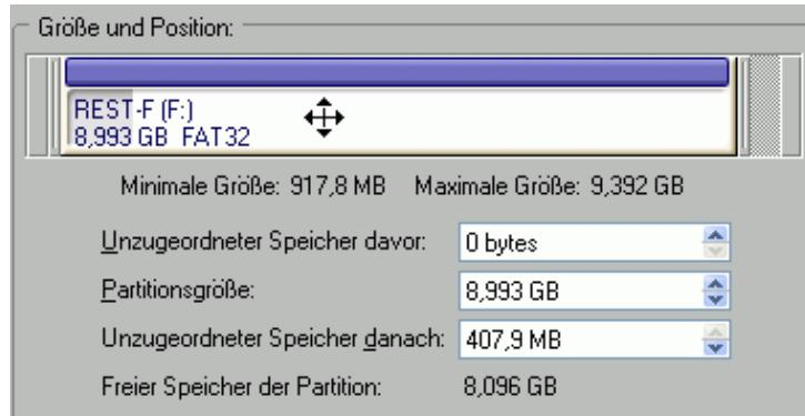
Ziehen Sie nun den ganzen Bereich F: nach links, nun wird dadurch der bisher Unbenutzte Speicher neu belegt/verwendet.
